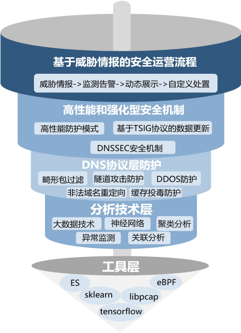
图二：DNS智能安全防护体系架构
